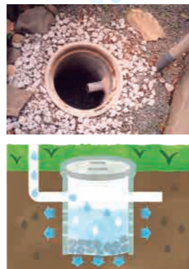
雨水浸透ます
